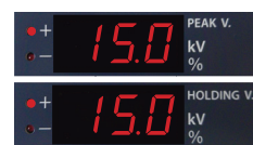
放電ガン先端での出力電圧
