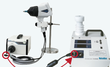
放電ガンの●●を ESD 電圧メータに接続
