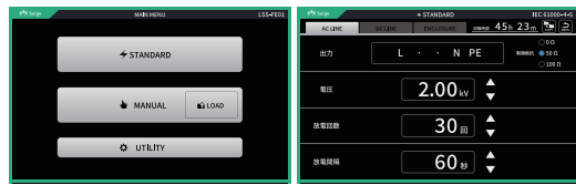
雷サージ試験器 LSS-FE01 Series
