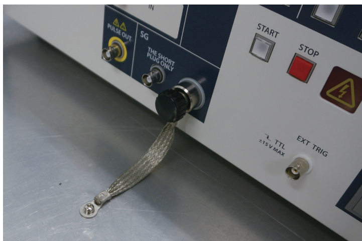
試験配置と接地ケーブル接続の例
