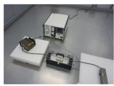
カップリング・アダプタを使用した ノイズ耐性評価
