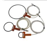
本プローブは、インパルスノイズ試験器と組み合わせることにより、電子機器内部の配線(PC ボード)等に電磁界による輻射ノ イズを与え、電子機器の輻射ノイズに弱い部分を探すためのものです。
