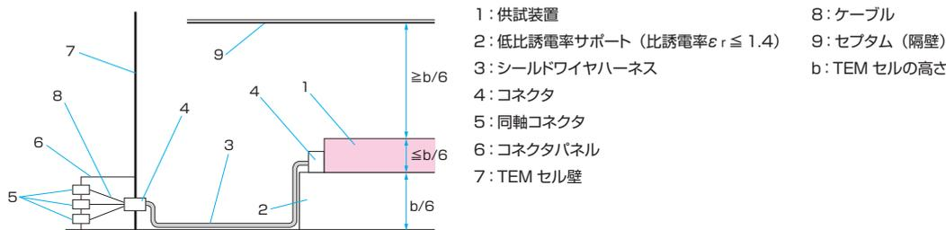
※ 上記、2種類の試験において配線ハーネスの数が膨大でローパスフィルタを使用できない場合は、TEMセルを貫通させて試験を行うことができます。ただし、その場合は遮蔽されたシールドルームなどで試験を実施する必要があります。(詳細は省略。)
