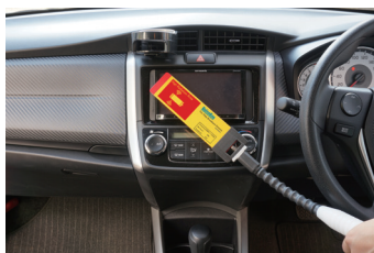
広帯域スリーブアンテナを使用した車内での試験イメージ
