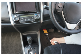
広帯域スリーブアンテナを使用した車内での試験イメージ
