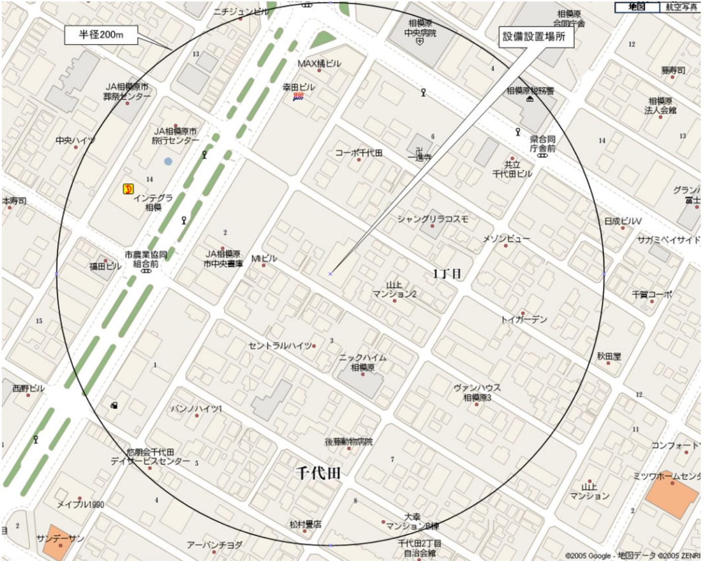
設置場所付近の図面は、その設置場所を中心とした概略半径200メートルの円内の略図に建築物、道路及び空地等の状況を示したものです。工場内の敷地図、配置図等は従前のおり不要です。
