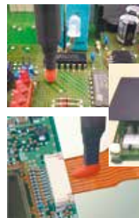
FNS使用時:電圧4kV以下
