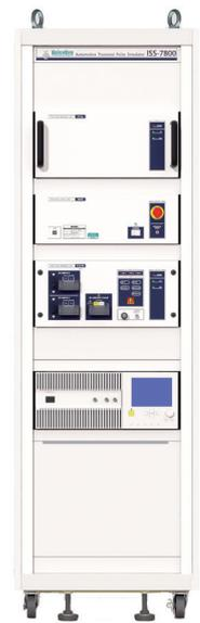
車載過渡サージ試験器
