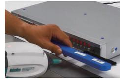
静電気試験を実施する際に、供試体（EUT / DUT）が蓄積している電荷を除去するためのブラシです。
