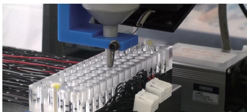
上記は約 60 線へのワイヤハーネスに対して気中放電にて試験を実施する際の例です。この場合、6000 回の放電試験を全て自動にて実施する事ができるようになります。
