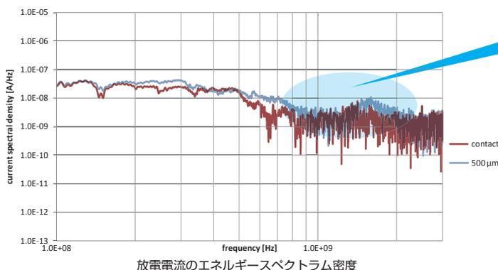
接触(Contact)放電に比べ、微小ギャップ放電の方が高い周波数成分のノイズが多く出ていることが確認できます。
