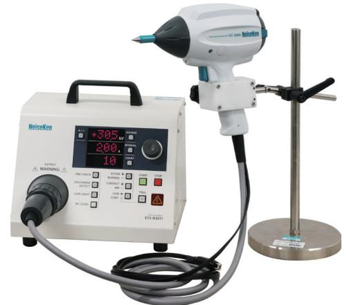
※放電ガンのCRユニットを100pF-1.5kΩまたは200pF-0Ωの定数に交換頂いても、半導体静電気試験の試験仕様(規格で定められた波形規定)は満たしませんのでご注意ください。
