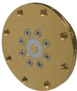
IEC 61000-4-2 Ed.2.0 規格で要求される抵抗負荷です。静電気放電の電流波形を測定する際に使用します。
