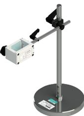
静電気試験器用放電ガンを固定する際に用いるプローブスタンドです。（IEC 規格対象外品）
