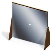
IEC 61000-4-2 / ISO 10605 Ed.2 規格の静電気放電発生器の動作を簡易的に確認する際に使用する負荷抵抗器(ターゲット)を取り付ける板です。負荷抵抗器(06-00067A)を取付け、波形を簡易的に測定する為の治具です。寸法 1.2m × 1.2m
