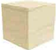
床置き機器などに対する静電気試験を行なう際に、機器をグラウンドプレーンより 10cm 浮かすために使用します。
