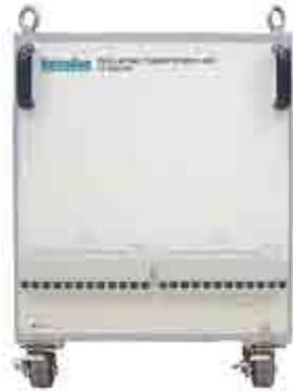
TF-6503P は最大単・三相 AC 600V/50A (TF-6633P は 63A)、絶縁耐圧 4kV の絶縁トランスユニットです。当社の雷サージ試験器 AC ライン電源用に使用でき、各種ノイズ試験や測定機器用としても使用することができる、汎用性の高い絶縁トランスユニットです。
