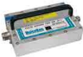
高電圧パルスを4:1に分圧して出力することで、低電圧での試験を実現するための分圧器です。
