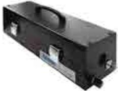
CA-805B は、インパルスノイズ試験器と組み合わせることにより、電子機器のケーブルを挟むだけでノイズを印加することができます。
